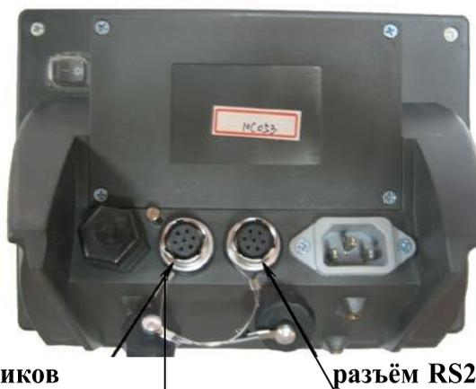
разъём для тензодатчиков
