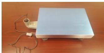
Шаг 2: Соедините разъемы проводов, идущие от блока управления и от весовой платформы.
