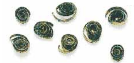
Толстая, тяжелая, с голубым отливом стружка - полотно перегружено
